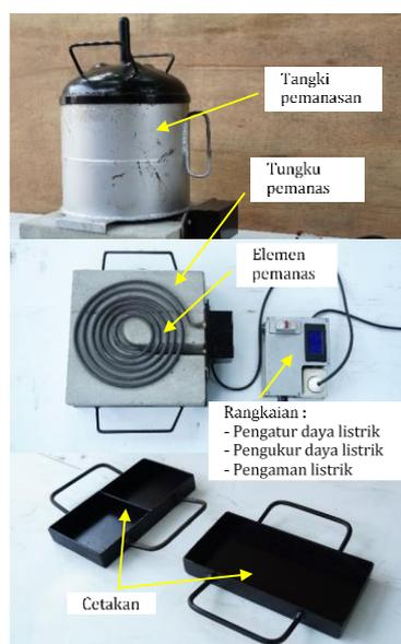
Gambar 4. Komponen Alat Pengolah Sampah Plastik Residu
